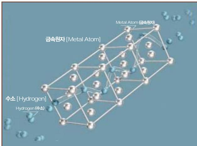
순수 수소 서비스에서 수소투과는 운동 에너지에 의해 발생합니다. 공정이 고온 또는 고압일 때 수소 분자는 서로 충돌하여 운동 에너지를 방출합니다. 이 운동 에너지는 수소 분자의 결합을 파괴하여 수소 이온을 생성합니다. (H<sub>2</sub> → 2H<sup>+</sup>) 얇은 박막으로 격자 구조된 금속 격막 다이어프램의 반대쪽에 모이면, H<sup>+</sup>이온이 H<sub>2</sub> 분자를 통과한 다른 H<sup>+</sup>이온으로 재구성합니다.
