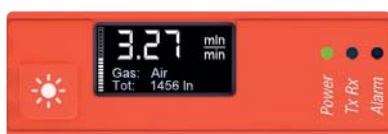
Fig.1 Display SPOT with default parameters
